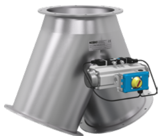
Příklad: Rozdělovací klapka s límcem 50°, symetrická, tvar DN > 300 mm s navařenými přírubami, pneumaticky poháněná s rotačním pohonem
